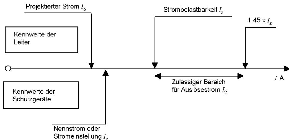
Bild D.2 – Kennwerte der Leiter und Schutzgeräte
