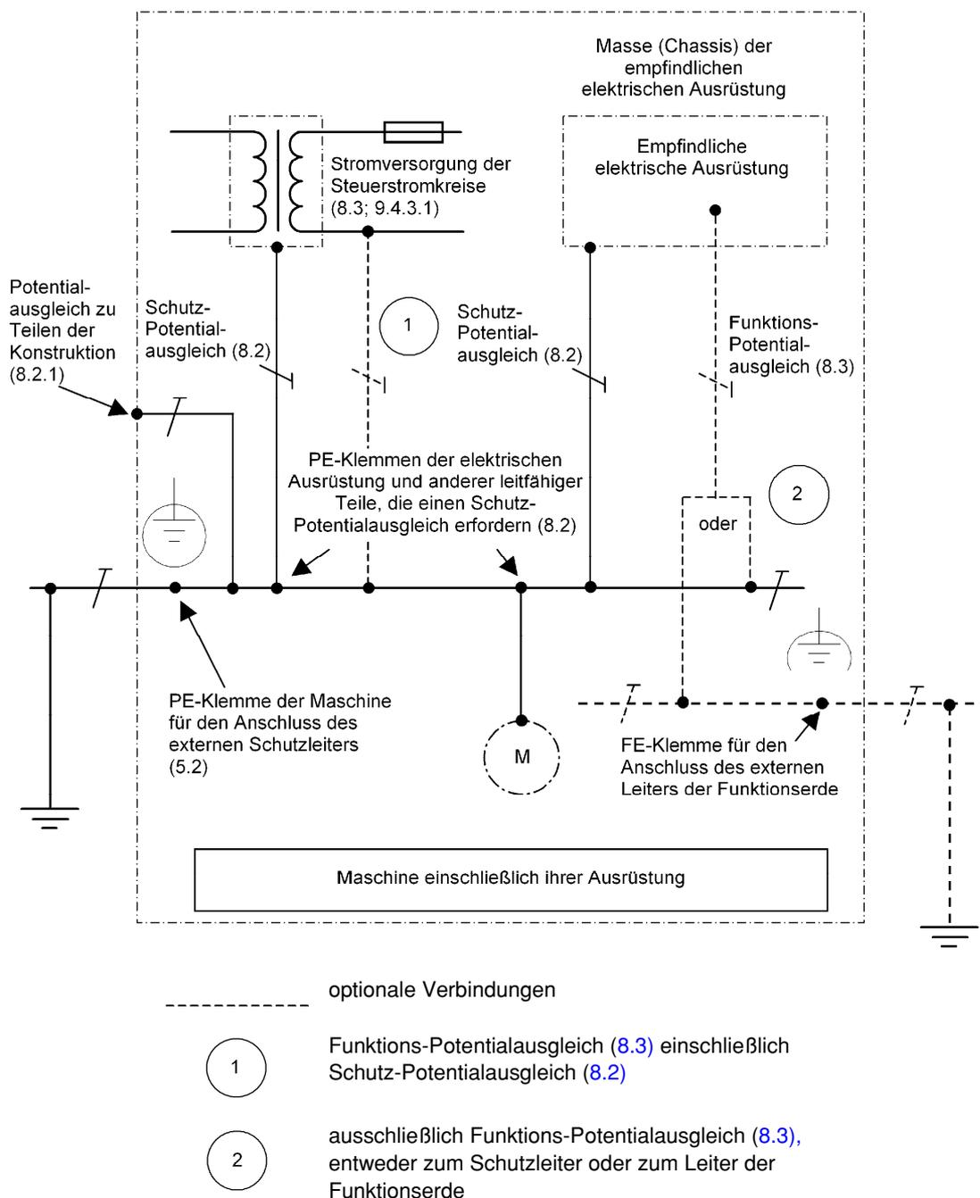
ANMERKUNG Der Leiter für Funktionserdung wurde früher „fremdspannungsarmer Erdleiter“ genannt, und die „FE“-Klemme war mit „TE“ bezeichnet (siehe IEC 60445).
