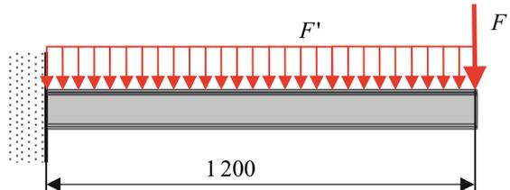
3. Der Träger mit skizzierten Profil wird durch die beiden Einzellasten  $F = 20 \text{ kN}$  und die Streckenlast  $F' = 4 \frac{\text{kN}}{\text{m}}$  belastet. Ermitteln Sie die maximale Biegespannung. An welcher Stelle im Träger tritt sie auf?
