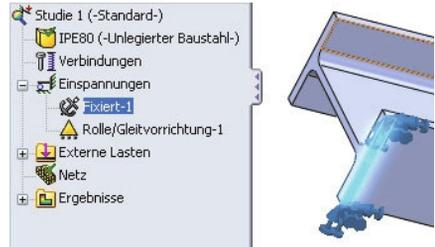
5. Definieren Sie das Loslager mit **Rolle/Gleitvorrichtung** an der ebenfalls 5 mm breiten Fläche auf der gegenüberliegenden Seite.
