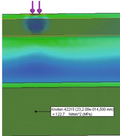
Für die Verformung erhält man mit *Sondieren* eine maximale Verformung von ca. 1,27...1,29 mm in der Balkenmitte. Der berechnete Wert 1,24 mm liegt sehr nahe am simulierten Wert.
