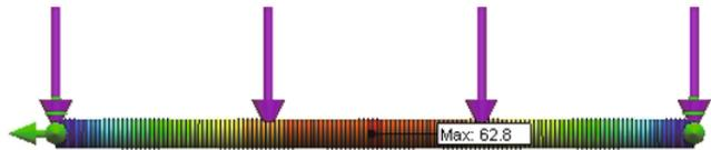
Die maximale Verformung beträgt 0,80 mm.
