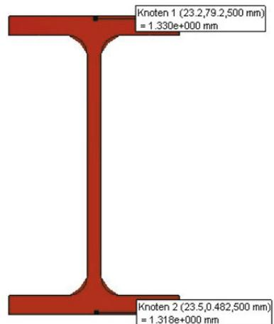
An der Unterkante liegt der Spannungswert von  $124,2 \frac{\text{N}}{\text{mm}^2}$  sehr nahe beim analytischen Wert  $\sigma_b = 125 \frac{\text{N}}{\text{mm}^2}$ . Die simulierte Verformung 1,32...1,33 mm kann analog ermittelt werden. Sie weicht weniger als ein Zehntel Millimeter vom analytischen Wert ab.
