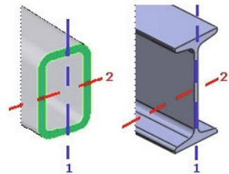
Die Balken in diesem Lehrbuch haben einen rechteckigen Querschnitt. Die lange Seite des Rechtecks ist Richtung 1, die kurze ist Richtung 2.
