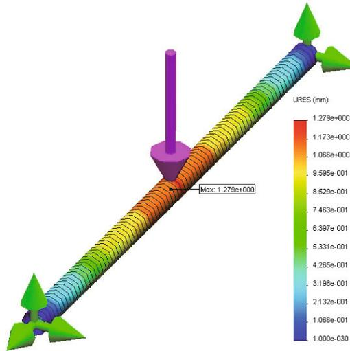
Wenn Sie mit Balkenelementen arbeiten, können auch Querkraft- und Biegemomenten-Verläufe dargestellt werden. Mit Rechtsklick auf **Ergebnisse** wählen Sie **Balkendiagramme definieren**. In diesem Menü können Sie nun auswählen, welches Balkendiagramm dargestellt werden soll. Für den Querkraft-Verlauf wählt man **Schubkraft in Richtung 1**:
