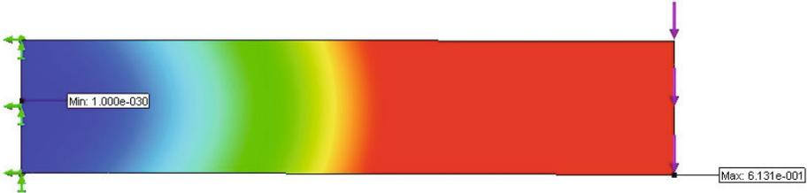
Der maximale Verformungswert liegt bei 0,61 mm. Dieser Wert liegt nahe am analytisch berechneten Wert 0,595 mm.
