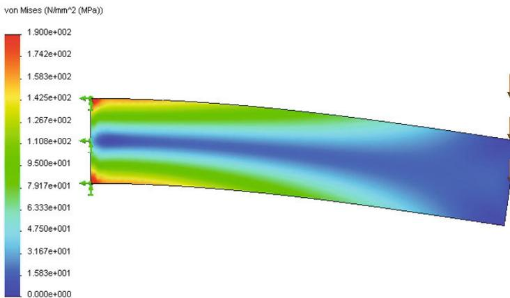
Bei der dargestellten Spannungsverteilung sieht man, dass die neutrale Faser in der Mitte des Bauteiles praktisch spannungsfrei ist. In den beiden äußersten Randfasern werden sich die gleichen Spannungsbeträge aufbauen.
