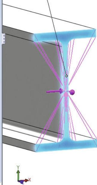
Die Position der **Abgesetzten Last** sollte sich im Schwerpunkt der Fläche befinden. Geben Sie deshalb die unter **Speicherort** dargestellten Werte ein. Sie beziehen sich auf den Ursprung des Trägers. Das heißt: Der Schwerpunkt der Fläche <1> hat die Koordinaten (23 mm/40 mm/1000 mm).
