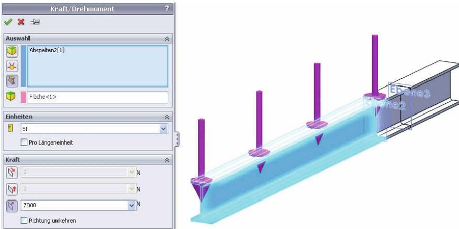
7. Definieren Sie die Einzellast  $F_1 = 6\,000\text{ N}$  auf dem Knoten. Wählen Sie dazu den unten dargestellten Knoten
