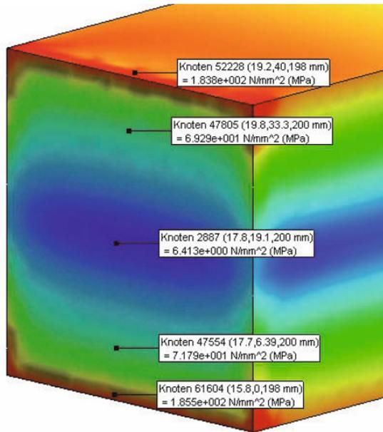
Der oberste sondierte Wert von  $184 \frac{\text{N}}{\text{mm}^2}$  liegt nahe beim berechneten Wert von
