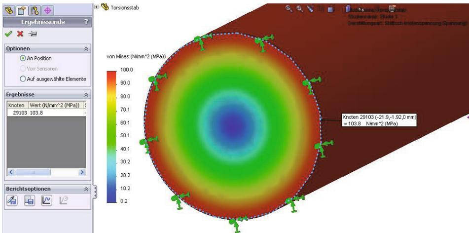
Die maximale Von-Mises-Spannung beträgt  $103,8 \frac{\text{N}}{\text{mm}^2}$ . Wenn man die obige Torsionsspannung mit der Festigkeitshypothese Von-Mises in eine Normalspannung mit  $\sigma_b = 0 \frac{\text{N}}{\text{mm}^2}$  umrechnet, erhält man:
