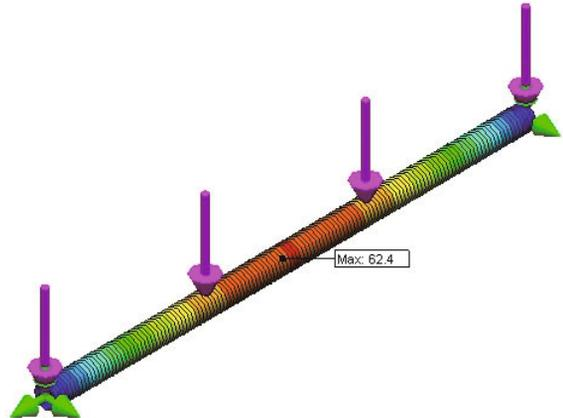
Die maximale Durchbiegung in der Mitte beträgt ca. 0,79 mm.
