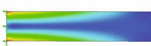
Auch beim Torsionsstab sieht man, wie die Spannungen gegen die Mitte immer kleiner werden:
