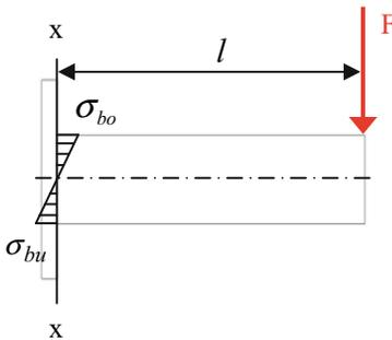
Da es sich um ein symmetrisches Bauteil handelt, sind beide Spannungen gleich groß. Sie lassen sich folgendermaßen berechnen:
