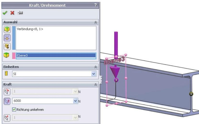
8. Vernetzen Sie mit einer Elementgröße von 7 mm und führen Sie die Studie aus.
