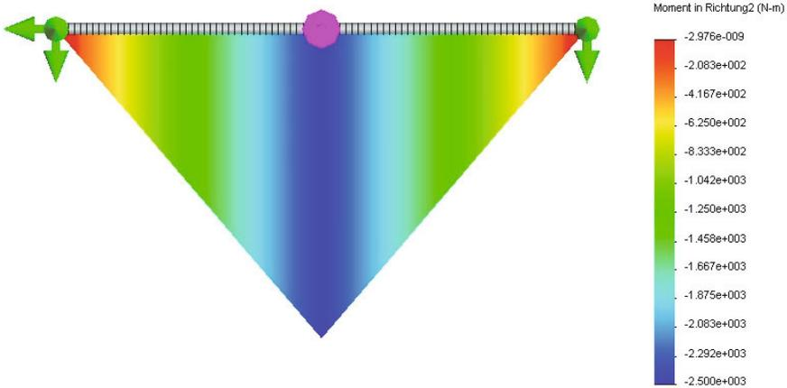
Warum wählt man beim Querkraft-Verlauf **Schubkraft in Richtung 1** und beim Biegemomenten-Verlauf **Moment in Richtung 2**?
