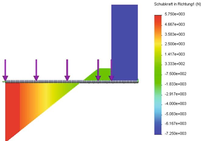
Dieser Querkraft-Verlauf stimmt mit dem „von Hand“ erstellten überein. Der Unterschied besteht nur darin, dass dieser Graph an der x-Achse gespiegelt ist, was auf eine andere Vorzeichenregel schließen lässt. Uns interessieren aber der Verlauf und die Beträge der Kraft. Oben haben wir berechnet:  $F_A = 5\,750\text{ N}$  und  $F_B = 7\,250\text{ N}$ . Diese Werte stimmen genau mit den Simulationen überein.
